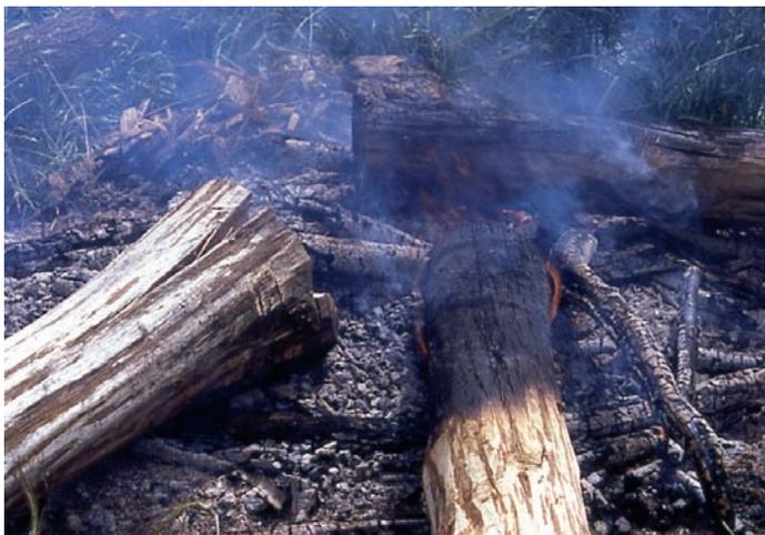
Abb. 4: Ankohlen der unteren Pfostenenden in einem Schwelbrand.
