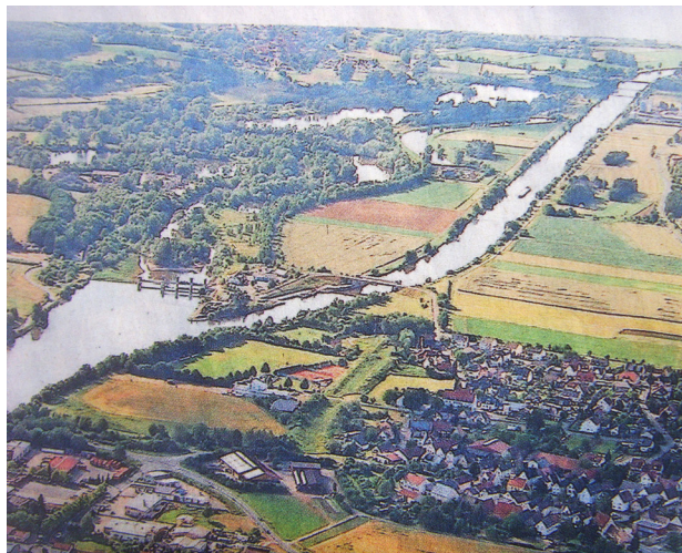
Abb. 183: Ortsbereich Neuses: links die Regnitz mit Abzweig des MD-Kanals nach rechts oben; in der Verlängerung des Kanals nach unten ist die gebogen verlaufende Trasse des Ludwigskanals zu sehen. Die geschwungene Baumreihe in der Mitte zwischen Regnitz und MD-Kanal zeichnet den Verlauf des ehemaligen Werkkanals nach. Blickrichtung Nord. Foto: Marquard Och 2013
