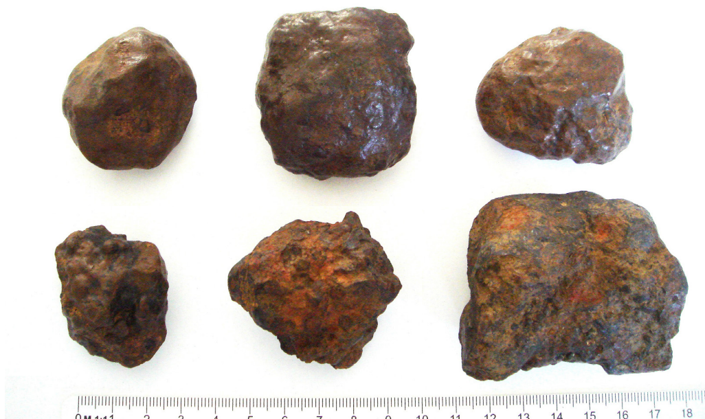
Abb. 7: Große Bohnerze aus der Ulrichszeche, die aus kleineren Bohnerzen bestehen, die limonitisch verbacken sind. Der glänzende Überzug könnte Wüstenlack sein.
