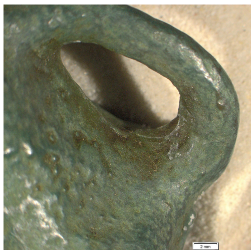
Abb. 25: Gussgrad in der Öse. Foto: H. Trauner (NHG).
